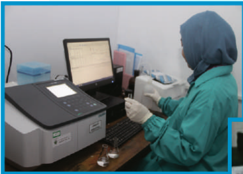
Pembacaan sampel surfaktan /deterjen menggunakan Spektrofotometer
