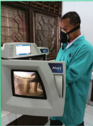
Destruksi sampel padat dengan alat microwave digester
