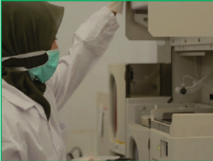
Destruksi spesimen darah dengan microwave digester
