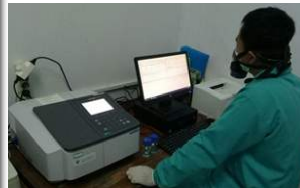
Pembacaan sampel surfaktan/deterjen menggunakan Spektrofotometer
