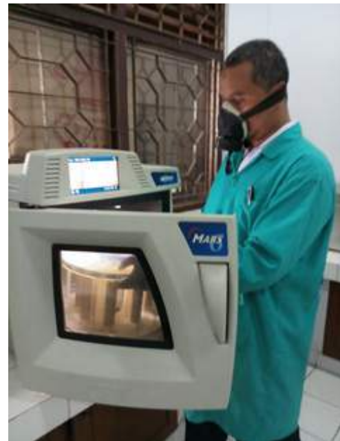
Destruksi sampel padat dengan alat microwave digester
