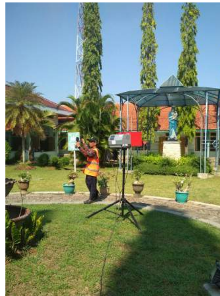
Pengukuran kecepatan angin dan pengambilan sampel udara lingkungan
