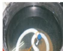
Gambar3 . Komponen dalam ember saat uji coba skala laboratorium terdiri dari air jernih, Sedimen coklat hasil koagulasi flokulasi, selang ulir isi pasir sebagai filter
