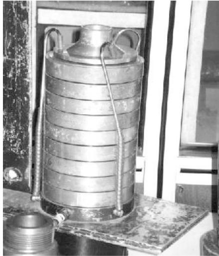
Gambar. 2 Alat ukur impaktor bertingkat Andersen
